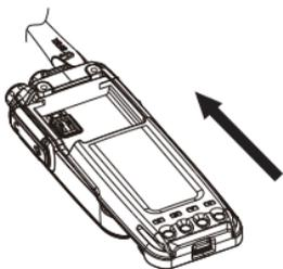
欲取下电池，请先将手持终端关机，然后将手持终端背面底部的门锁向上推，平行将电池上端往下推，取出电池。
