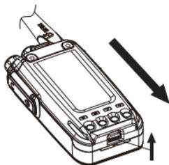
**注：请勿在手持终端处于开机状态下插、拔电池。**
